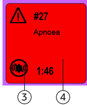
زر Alarm Indicator (مؤشر الإنذار) مع تفعيل كتم الصوت
